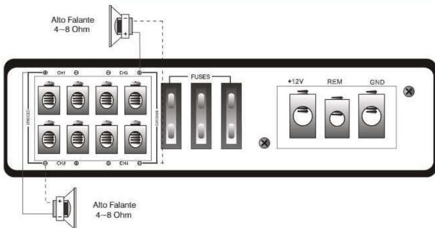
Repare que os quatro alto-falantes foram ligados na mesma polaridade dos terminais do amplificador (+) e (-) conforme mostra a figura acima .
