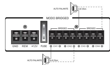
Repare que os quatro alto-falantes foram ligados na mesma polaridade dos terminais do amplificador (+) e (-) conforme mostra a figura acima. Se o seu alto-falante não possuir terminais marcados (+) e (-), uma marca vermelha no terminal indica a conexão do positivo (+). A ligação dos alto-falantes desta maneira garante que seus cones movam-se na mesma direção de acordo com a gravação original. Se uma das ligações estiver invertida, a imagem estéreo e a resposta de graves será degradada.
