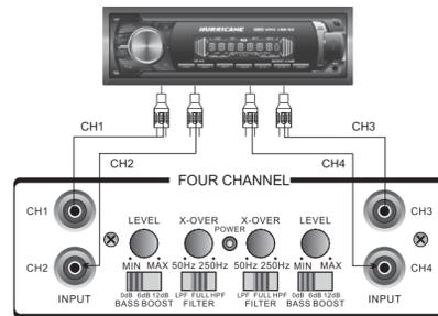
Entrada de baixo nível. Estas entradas são alimentadas pela saída de linha do seu rádio ou processador de sinal, ambas as entradas devem ser alimentadas com o mesmo sinal para uma operação adequada em BRIDGED. Se somente um sinal mono estiver disponível, é necessário usar um adaptador "Y".
